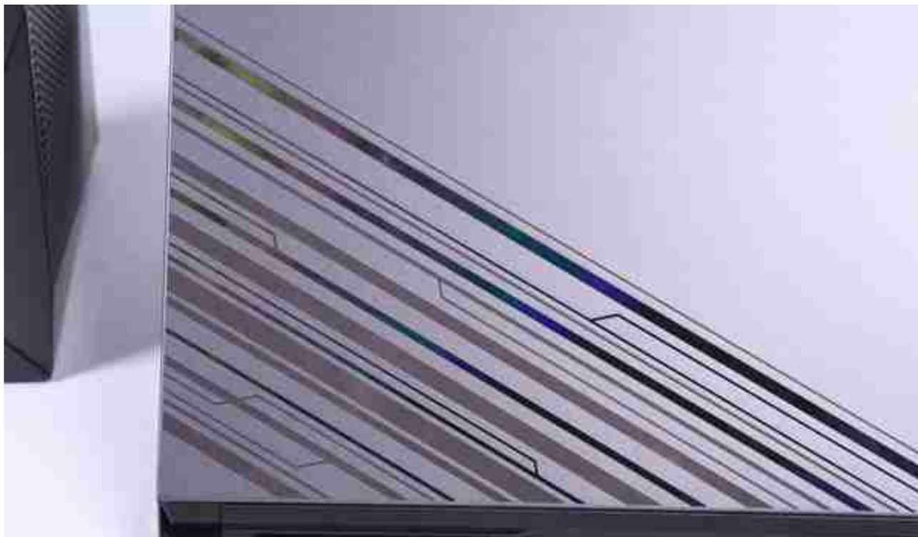
A面左下部机械革命使用了NIL技术的工艺，印刷了多条高亮线条，在不同角度和光照下呈现出不一样的色彩。
