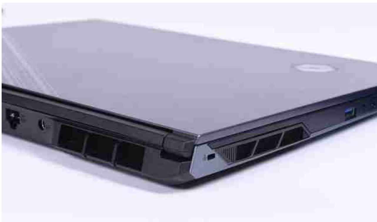
对于高性能游戏本来说，双风扇四出风口的设计是必不可少的。透过旷世16 Super的出风口我们可以看到体积巨大的黑化散热鳍片，对于提升散热能力有很大帮助。
